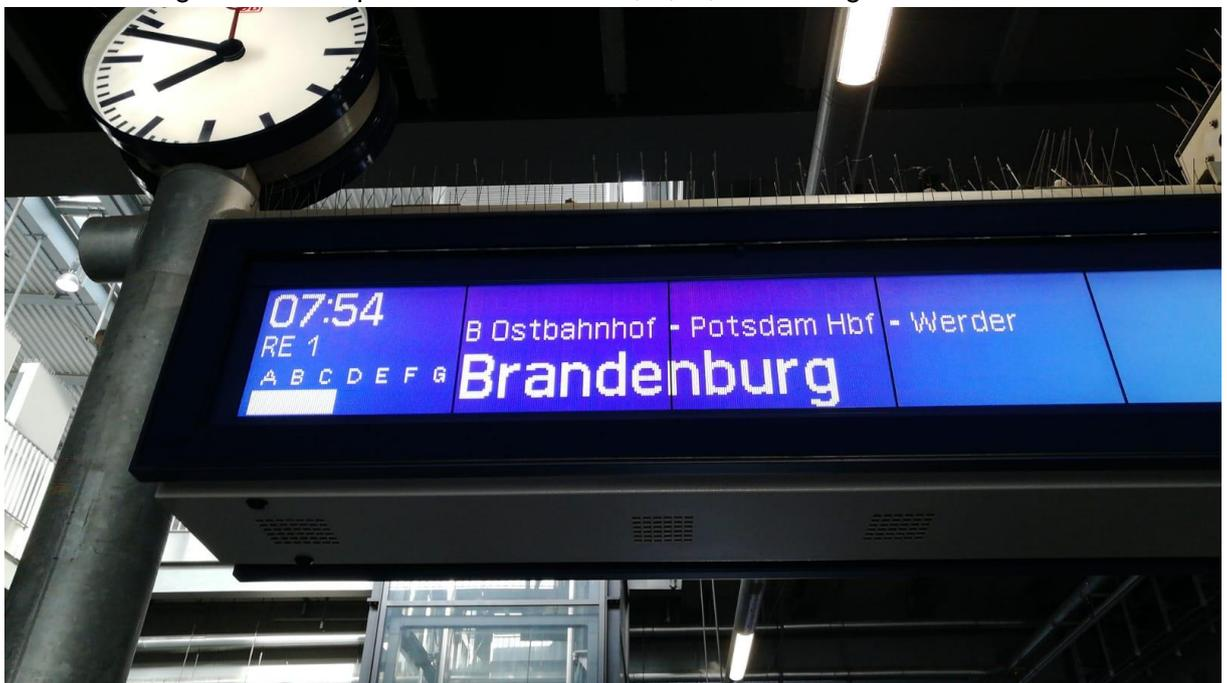
Derzeitiges Softwareproblem. Die Anzeiger zeigen immer A bis G an. Mit der Umsetzung IRIS+ Ende 2020/Anfang 2021 können die Anzeiger das flexibel anzeigen.
